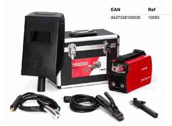
PRACTICO 150. Intensidad de soldadura: 150Amp. Rendimiento: 40% a 40°C. Válida para generador. Para electrodo de 2,5mm continuo y hasta 3,25m. Se suministra con conjunto pinzas, pantalla de mano, piqueta y maletín. Peso: 2,1kg
